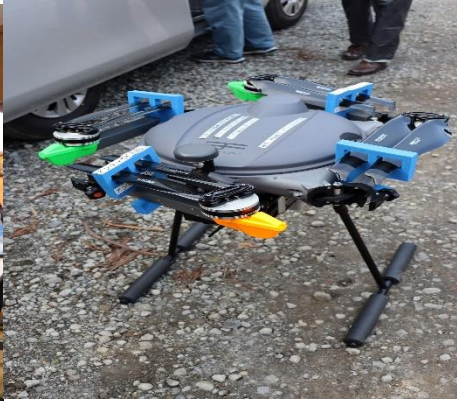
UAV レーザ測量用の大型ドローン
